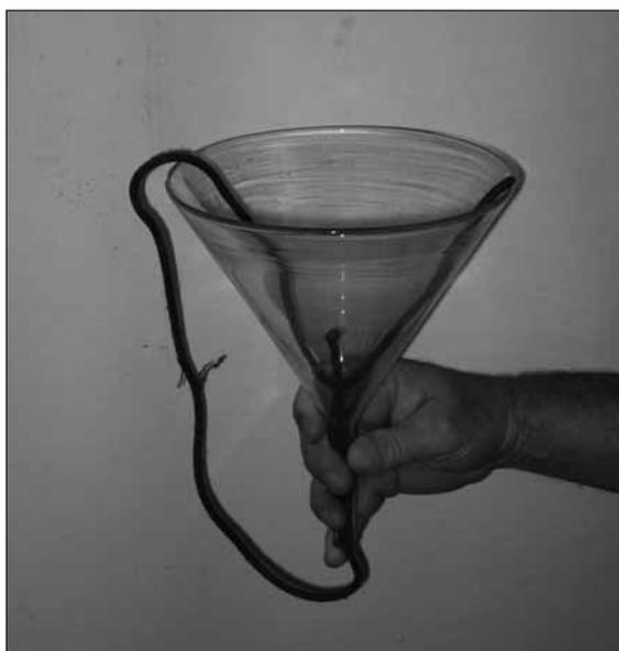
Fig. 30 - Imbuto utilizzato in una delle fasi di preparazione della miccia; dall'imbuto veniva fatta scendere la polvere nera che si avvitava alla iuta, creando la miccia (collezione Giuseppe Vezzoni).
